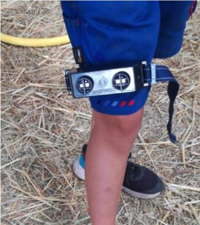
Abbildung 4. Zur Aktivierung des ShepHerd Halsbands am Bein eines Kindes waren durchschnittlich fünf Laufschrte notwendig
